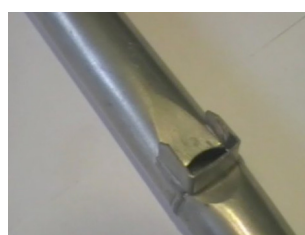
Pfeifen des Salicional 8' mit sog. Kastenbärten
